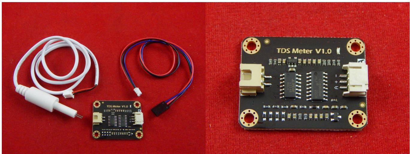
TDS метр предназначен для измерения количества растворённых твёрдых веществ в воде и её удельной электрической проводимости. Используйте датчик для проверки эффективности очистки питьевой воды в бытовом фильтре, анализа качества дистиллированной воды или приготовления питательного раствора в гидропонных системах.
