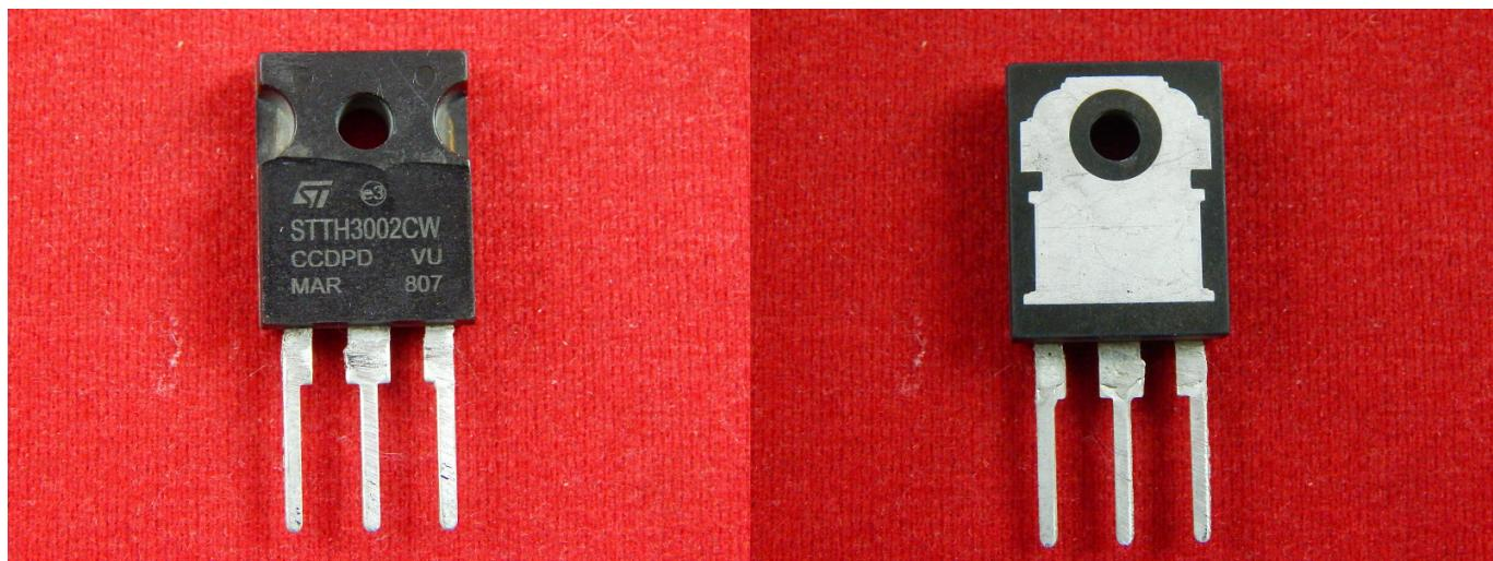
Диод — двухэлектродный электронный компонент, обладающий различной электрической проводимостью в зависимости от полярности приложенного к диоду напряжения. Диоды обладают нелинейной вольт-амперной характеристикой, но в отличие от ламп накаливания и терморезисторов, у диодов она несимметрична.
