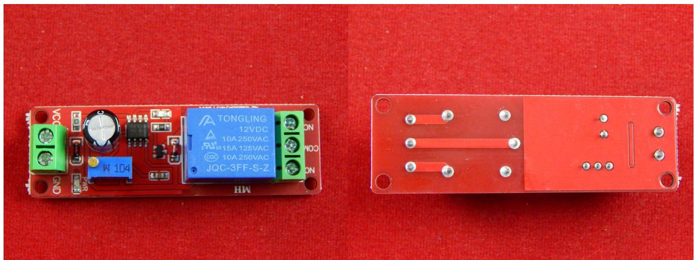
Модуль времени с таймером NE555 0-10 сек. 12V - модуль электромеханического реле JQC-3FF-S-Z и микросхемой таймера NE555, что позволяет выставлять задержку работы от 0 до 10 секунд.
