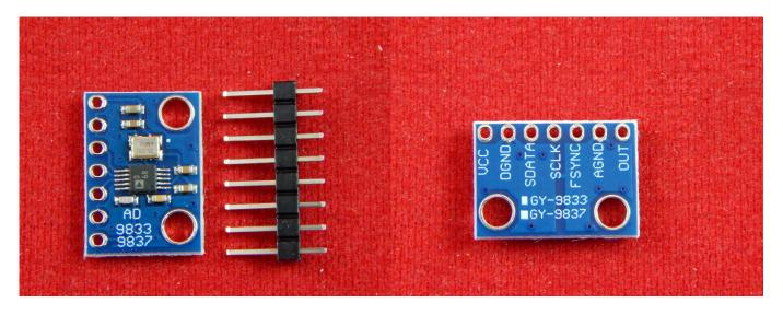
Миниатюрный модуль - программируемый генератор сигналов на базе AD9833.
