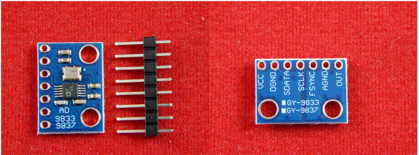
Миниатюрный модуль - программируемый генератор сигналов на базе AD9833.
