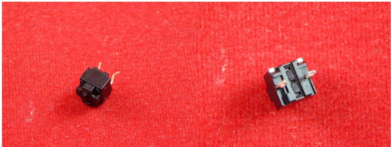
Тактовая кнопка — простой, всем известный механизм, замыкающий цепь пока есть давление на толкатель.
