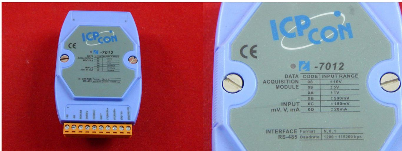
Модули аналогового ввода используют микропроцессорный интегрированный аналого-цифровой преобразователь для преобразования сигналов термопары в цифровые данные. Затем цифровые данные переводятся либо в технические единицы, либо в шестнадцатеричный формат, либо в процентах от полномасштабного диапазона (FSR) в соответствии с конфигурацией модуля.
