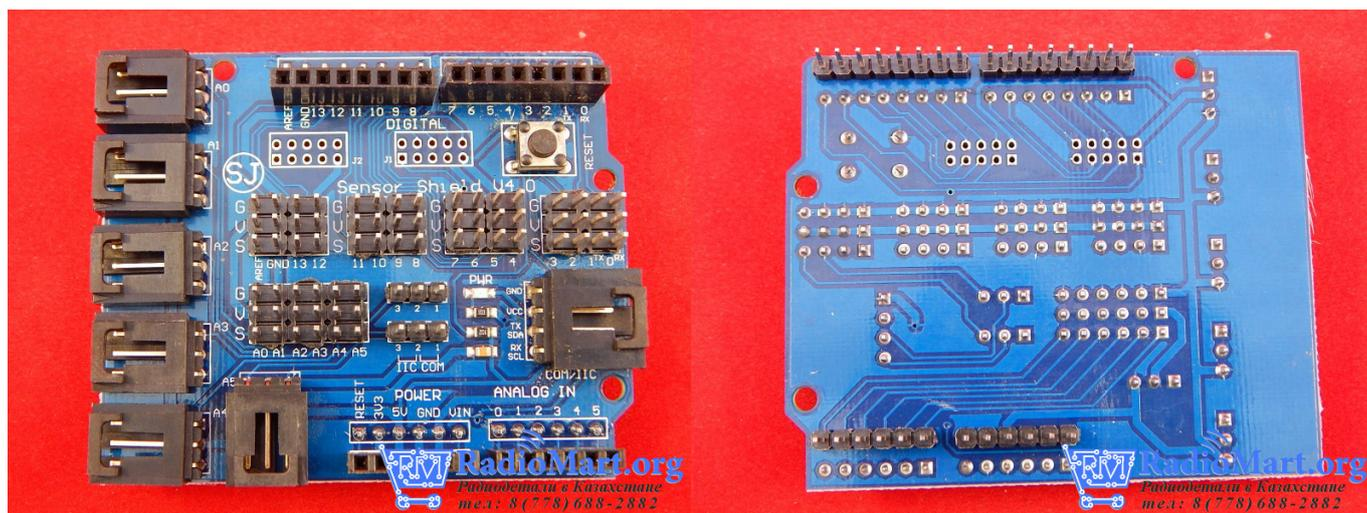
Плата для подключения датчиков для ардуино (Xduino Sensor Shield V4.0)
