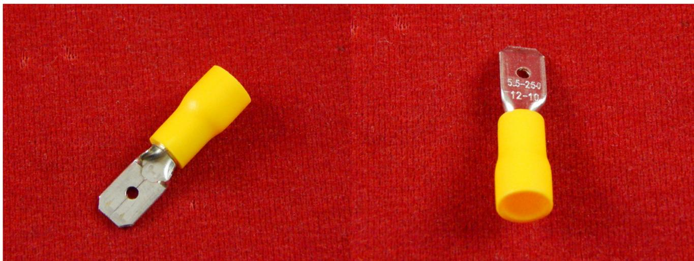
MDD5.5-250 — служит для обеспечения разборного качественного контактного соединения проводников сечением 4.0-6.0 мм<sup>2</sup>, максимальной силой тока 24А с выводами различных электротехнических приборов и устройств. Ширина контактной части ножевого наконечника 6.35 мм, подключаемый контакт 0.8x6.35 мм.
