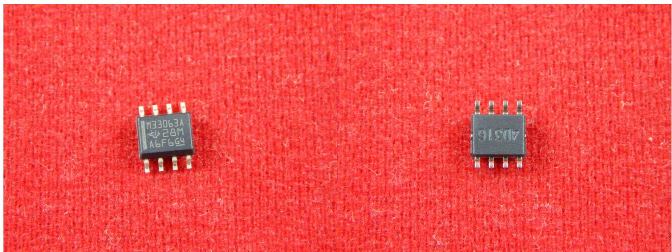
MC33063ADR — это инвертирующий импульсный регулятор, подходящий для использования с простыми преобразователями DC-DC. Устройство требует минимальных внешних компонентов для создания преобразователей в повышающей, понижающей и инвертирующей топологиях. Он имеет частоту генератора до 100 кГц и внутреннюю опорную точность 2%.
