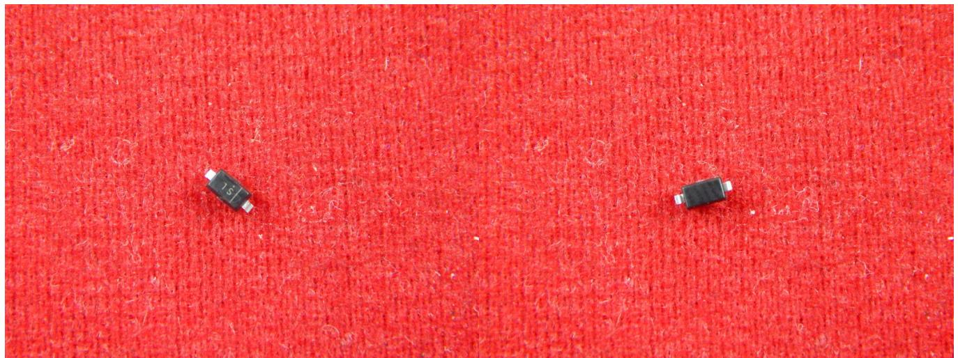
Диод Шоттки — полупроводниковый диод с малым падением напряжения при прямом пропускании тока.
