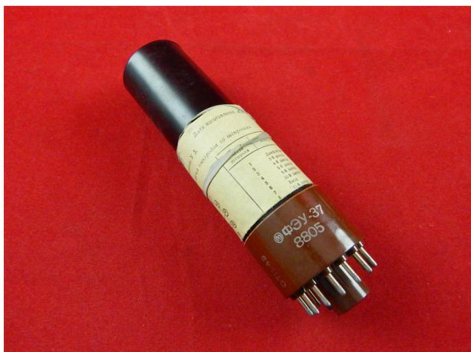
ФЭУ-37 - фотоэлектронный умножитель для спектрометрии гамма-излучений.
