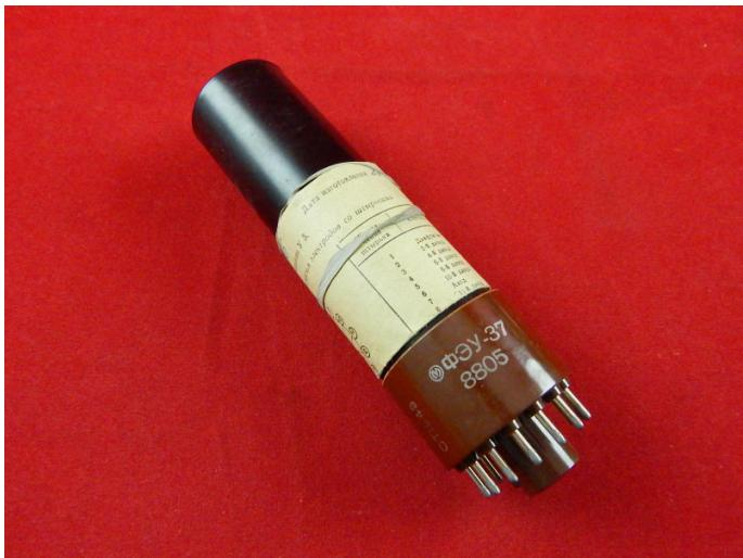
ФЭУ-37 - фотоэлектронный умножитель для спектрометрии гамма-излучений.
