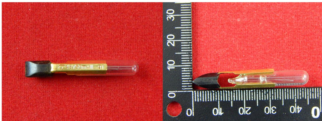
Коммутационные лампы используются в качестве источника света для световой сигнализации в различном оборудовании, устройствах автоматики и контроля и предназначены для включения в электрические сети постоянного или переменного тока.
