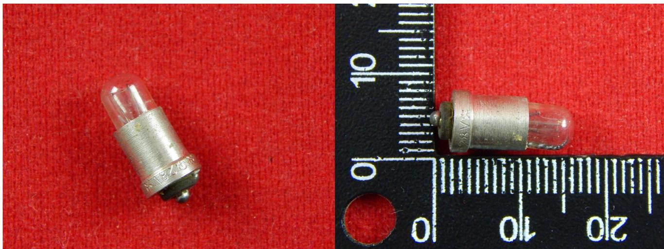
Лампа накаливания — искусственный источник света, в котором свет испускает тело накала, нагреваемое электрическим током до высокой температуры. В качестве тела накала чаще всего используется спираль из тугоплавкого металла либо угольная нить.
