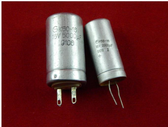
Электролитический конденсатор – один из самых распространённых радиоэлементов. Роль конденсатора в электронной схеме заключается в накоплении электрического заряда, разделения постоянной и переменной составляющей тока, фильтрации пульсирующего тока и многое другое.
