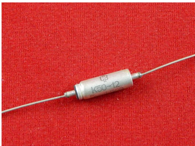
Электролитический конденсатор – один из самых распространённых радиоэлементов. Роль конденсатора в электронной схеме заключается в накоплении электрического заряда, разделении постоянной и переменной составляющей тока, фильтрации пульсирующего тока и многое другое.
