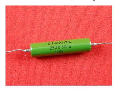
Конденсатор - один из самых распространённых радиоэлементов. Роль конденсатора в электронной схеме заключается в накоплении электрического заряда, разделения постоянной и переменной составляющей тока, фильтрации пульсирующего тока и многое другое.
