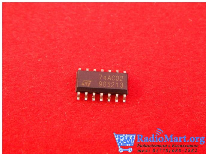
74AC02SC - Микросхема с функциональным назначением "Логическое ИЛИ-НЕ"
