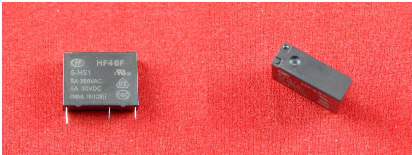
Реле — коммутационный аппарат, который при воздействии на него внешних физических явлений скачкообразно принимает конечное число значений выходной величины. Назначение реле заключается в автоматизации замыкания или размыкания электрической цепи.
