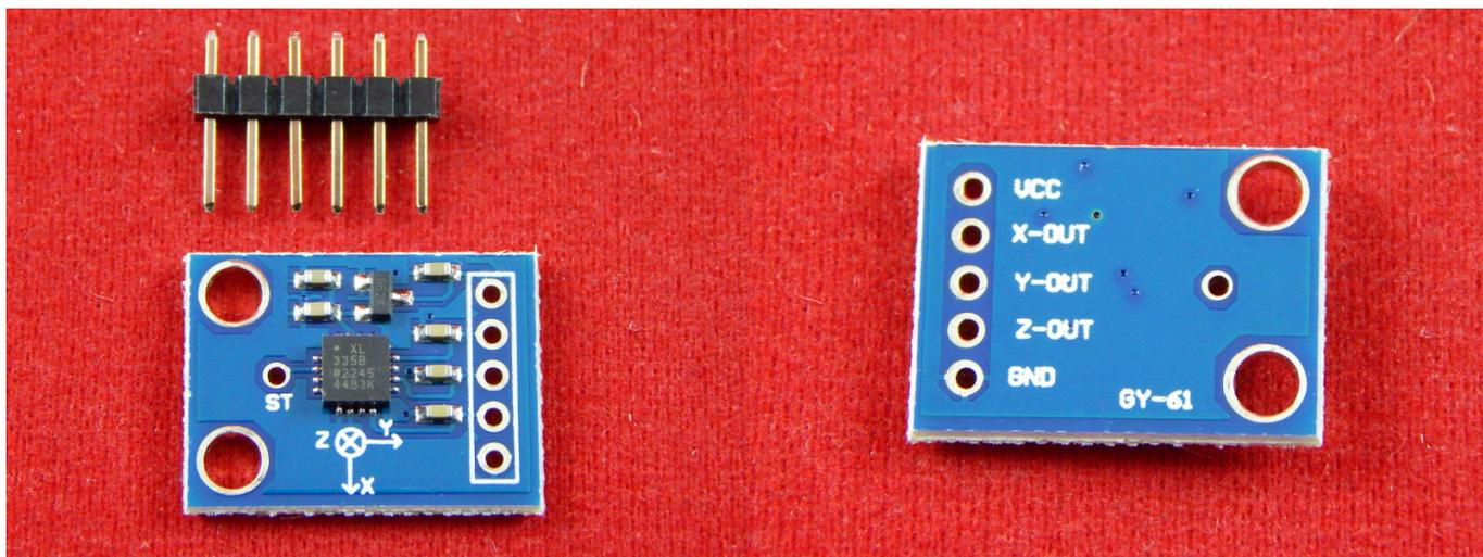
Акселерометр используют для определения вектора ускорения. Акселерометр ADXL335 имеет три оси, и поэтому может определять вектор ускорения в трёхмерном пространстве. Ввиду того, что сила земного притяжения - это тоже вектор, то акселерометр может определять свою собственную ориентацию в трёхмерном пространстве относительно центра Земли.
