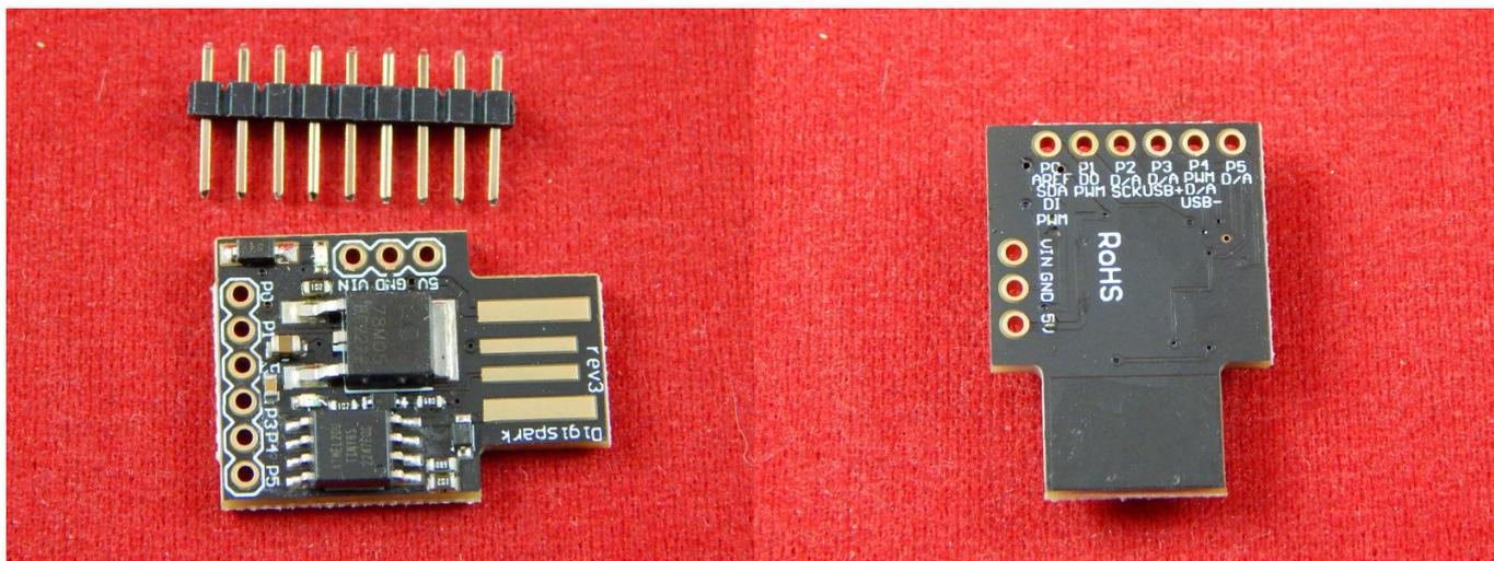
Отладочная плата на базе микроконтроллера Attiny85-20 в форм факторе USB.
