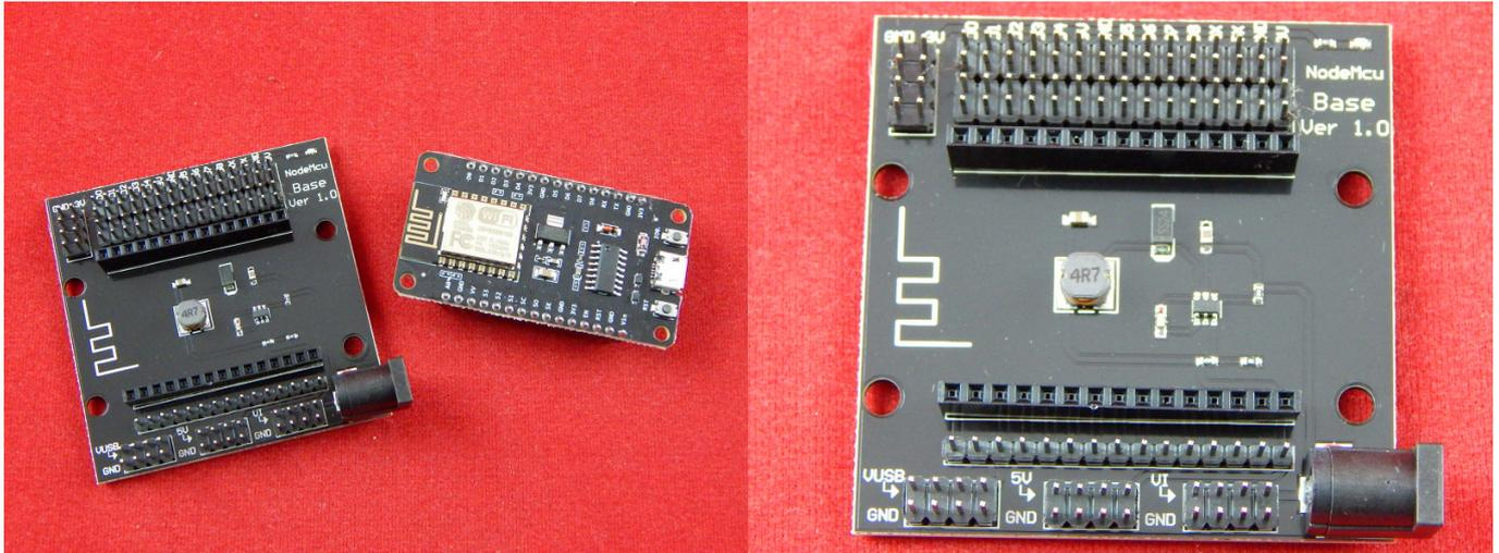
NodeMcu - платформа на основе ESP8266 для создания различных устройств интернета вещей (IoT). Модуль умеет отправлять и получать информацию в локальную сеть либо в интернет при помощи Wi-Fi. Недорогой модуль часто используется для создания систем умного дома или роботов Arduino, управляемых на расстоянии.
