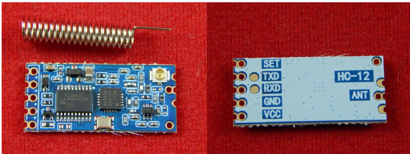
Беспроводной UART трансивер HC-12. Отличием данного модуля от других трансиверов является то что он подключается через UART интерфейс, а управление работой самого чипа SI4463 / SI4438 производится встроенным в модуль STM-микроконтроллером. Соответственно, HC-12 работает как беспроводной удлинитель UART.
