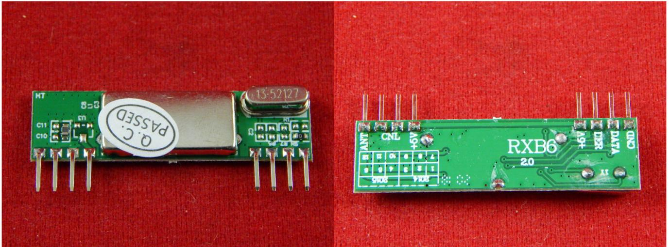
Супергетеродинный радиоприёмник — один из типов радиоприёмников, основанный на принципе преобразования принимаемого сигнала в сигнал фиксированной промежуточной частоты с последующим её усилением.
