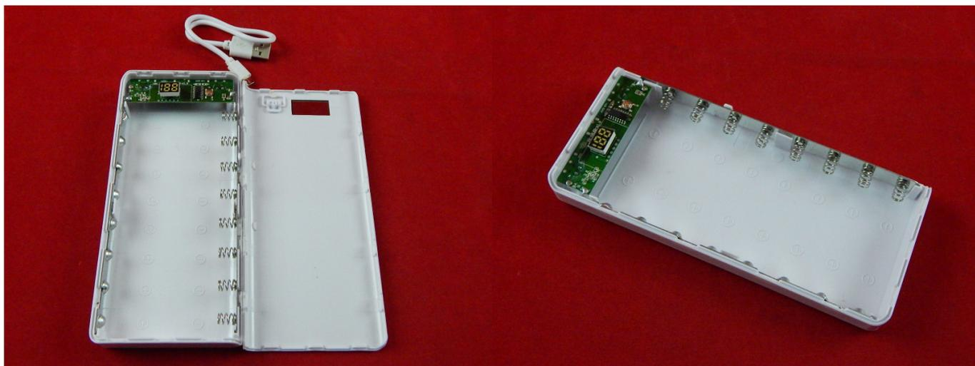
Корпус Power Bank с восемью отсеками под батареи типа 18650. Имеет отличное качество пластика, а так же удобный дизайн имеет данный корпус.
