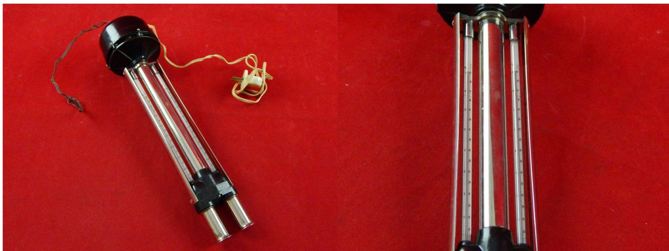
Психрометр аспирационный М-34 предназначен для измерения температуры воздуха, и температуры «смоченного» термометра с целью последующего вычисления параметров влажности воздуха. Измеренные значения температуры воздуха и температуры «смоченного» термометра позволяют вычислить относительную влажность воздуха в диапазоне от 10 до 100 % при температуре от -10 до 50°C.
