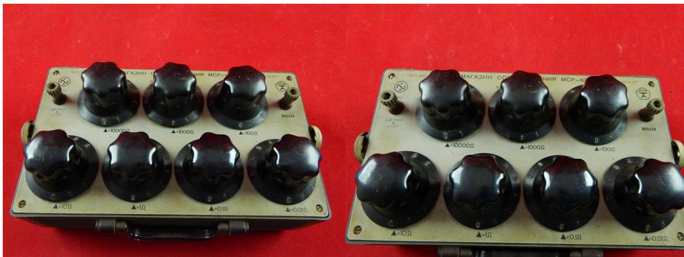
Мера электрического сопротивления — образцовые резисторы, специально сконструированные и изготовленные для использования в качестве мер электрического сопротивления.
