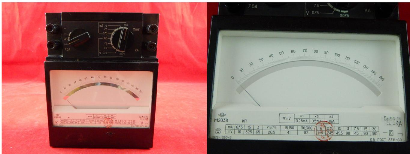
Вольтамперметр М2038 является измерительным устройством, используемым для контроля параметров электрических цепей постоянного тока. Отличительной особенностью этого прибора является возможность выполнения измерений в режиме вольтметра и амперметра, то есть один прибор позволит мерить и напряжение, и величину силы тока. Применяется на предприятиях энергетического сектора и лабораториях.
