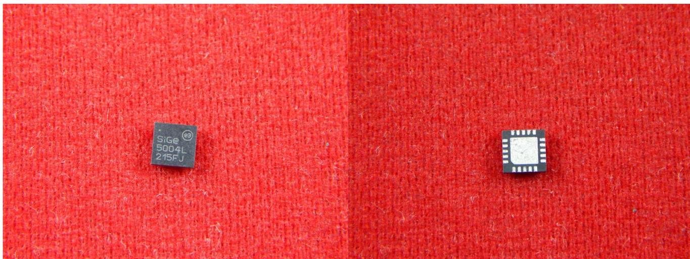
SE5004L является усилителем мощности 5ГГц, предлагающим высокую линейную мощность для беспроводных локальных сетей. SE5004L включает в себя детектор питания для мониторинга замкнутого цикла и контроля выходной мощности.
