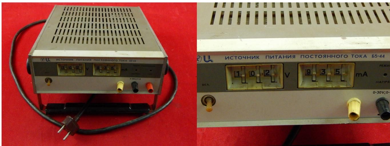
Источник питания постоянного тока Б5-44 предназначен для стабилизации постоянного напряжения или тока в зависимости от установленного режима. Прибор выполнен с использованием силового питающего трансформатора и линейного стабилизатора напряжения и силы тока.
