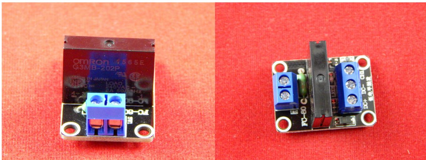
Модуль твердотельного реле SolidStateRelay-5V-1 - это одноканальный малогабаритный модуль реле на 5 В, управляемый с помощью контролера Arduino, 8051, AVR, PIC, DSP, ARM, ARM, MSP430, TTL logic или с компьютера.
