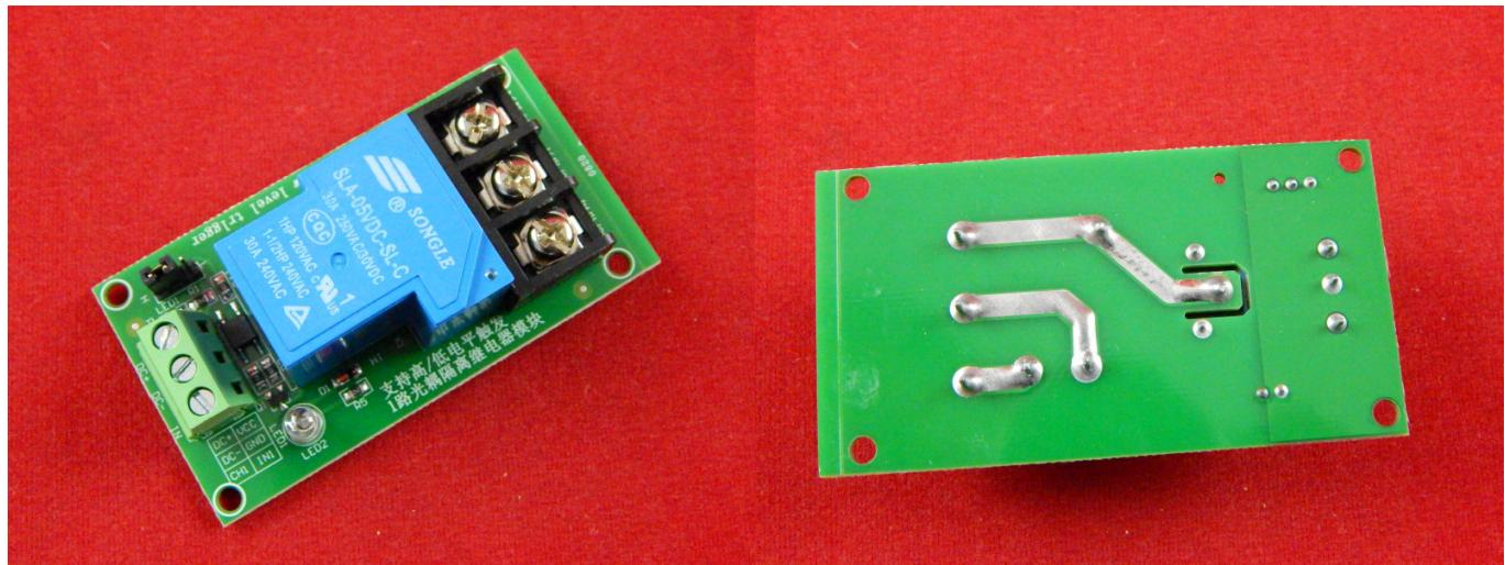
Модуль на основе электромагнитного реле SLA-05VDC-SL-C выдерживающего ток до 30A и оптрана PC817C.
