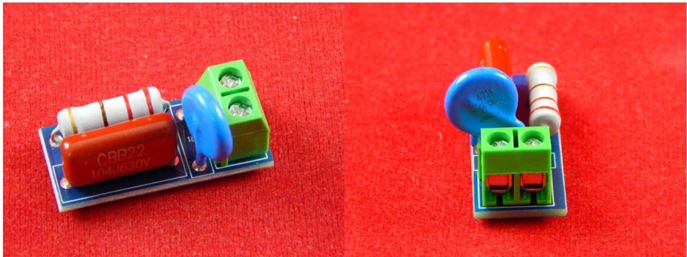
Модуль RC фильтра с варистором используемый для защиты реле от индуктивной нагрузки.
