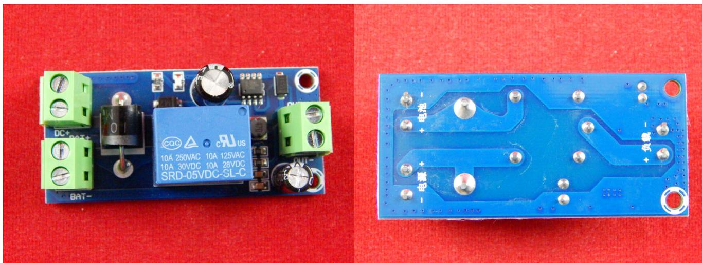
Модуль аварийного переключения питания YX-X804 необходим для переключения питания нагрузки на резервный источник питания в случае пропадания напряжения основного источника питания. Модуль YX-X804 можно использовать с аккумуляторными батареями с выходным напряжением 12, 24, 36 или 48 Вольт.
