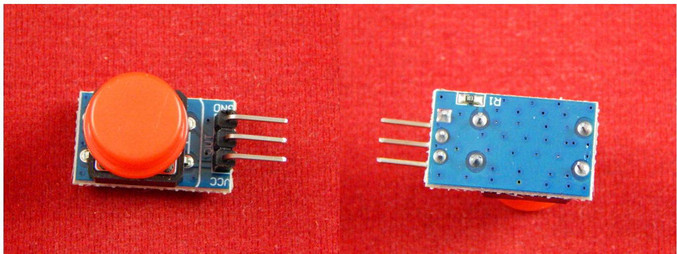
Данный модуль состоит из небольшой текстолитовой платы, на которой распаяны: тактовая кнопка 12x12 мм, притягивающий резистор и 3 пина для подключения к Arduino.
