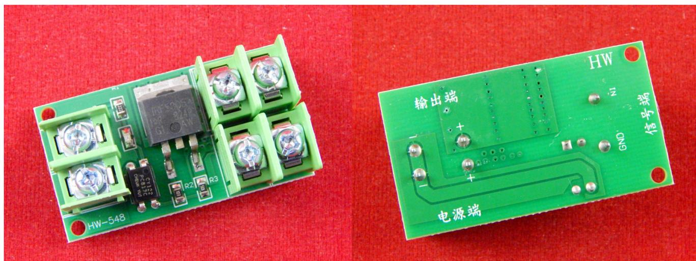
Драйвер на базе полевого транзистора F5305S. Модуль MOSFET транзистора (силовой ключ) имеет долгий срок службы, прост в управлении. Позволяет получить ШИМ до 36 В.
