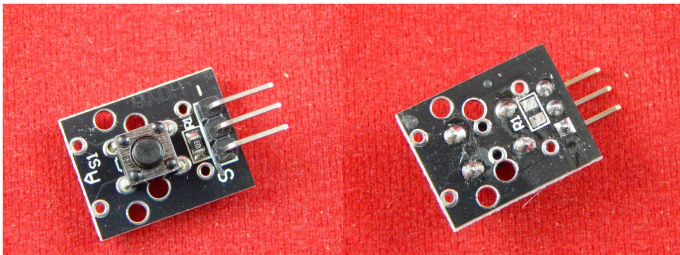
Модуль KY-004 представляет собой тактовую кнопку с обвязкой. А если быть точнее, то с установленным подтягивающим резистором 10 кОм. Данный модуль подключается по аналогии с подключением тактовой кнопки к Arduino, только не нужно устанавливать подтягивающий резистор.
