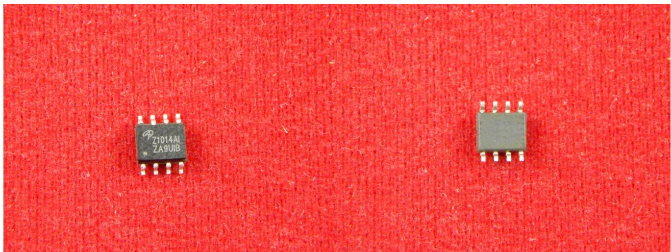
AOZ1014 - это высокоэффективный, простой в использовании регулятор 5А. AOZ1014 работает от диапазона входного напряжения 4.5 В до 16 В и обеспечивает до 5 А постоянного выходного тока с выходным напряжением, регулируемым до 0.8 В.
