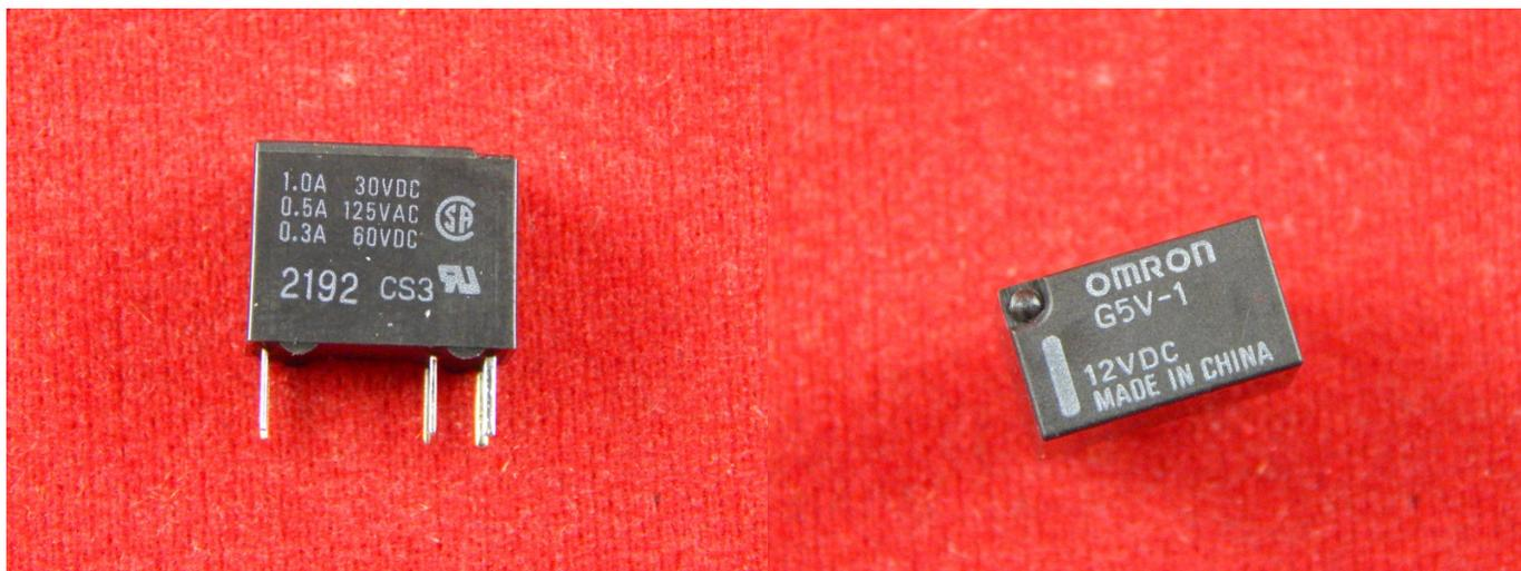
Реле Omron G5V-1 12VDC электромагнитное 0.5A 125VAC - используется для различных электронных схем.
