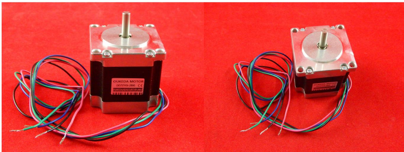
Шаговый двигатель это двигатель, ротор которого вращается не постоянно, а шагами. Полный оборот ротора состоит из нескольких шагов. Меняя форму сигнала, количество импульсов, их длительность и фазовый сдвиг, можно задавать скорость вращения, направление вращения и количество оборотов ротора двигателя. Двигатель работает от сигналов с напряжением от 12 до 24 В.
