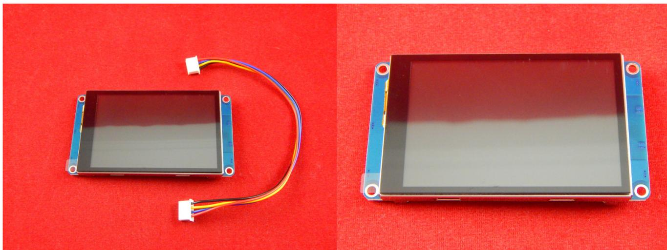
TJC4832T135\_011R - это удобный девайс, который обеспечивает интерфейс управления и визуализации между человеком и процессом, машиной, приложением или устройством. В основном применяется для интернет вещей или в области потребительской электроники. Это лучшее решение для замены традиционных LCD и LED Nixie дисплеев. Легко адаптируется к уже существующим проектам, нужно подключить его к UART.
