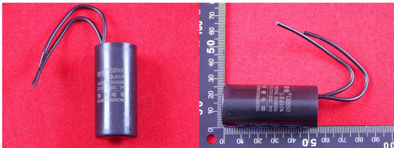
Конденсаторы СВВ60 – металлизированные полипропиленовые пленочные конденсаторы постоянной ёмкости в герметизированном цилиндрическом корпусе. Конденсатор СВВ60 может применяться как пусковой или рабочий.
