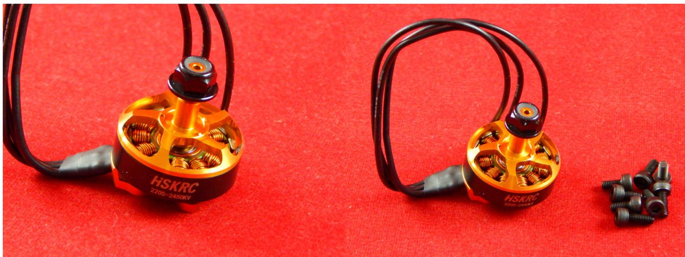
Бесщеточный малогабаритный мотор для создания мультироторных дронов.
