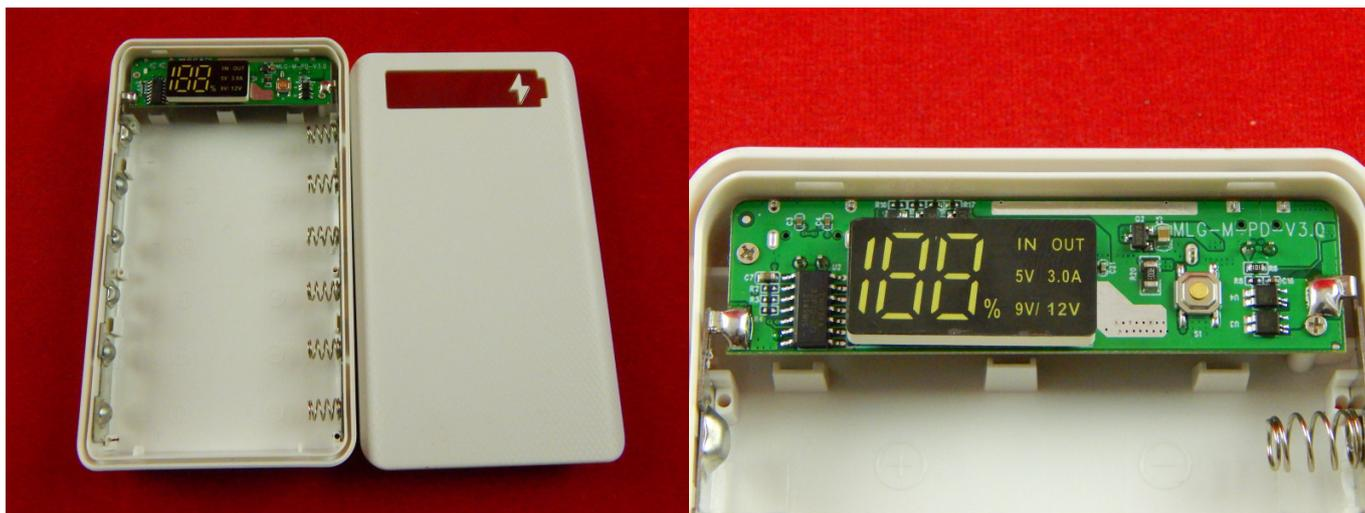
Корпус Power Bank с шестью отсеками под батареи типа 18650. Имеет отличное качество пластика, а так же удобный дизайн имеет данный корпус.
