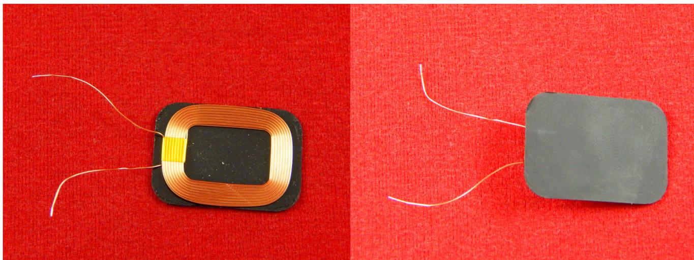
Данный модуль имеет Qi стандарт, разработанный Консорциумом беспроводной электромагнитной энергии WPC для индукционной передачи энергии на расстояние до 4 см.
