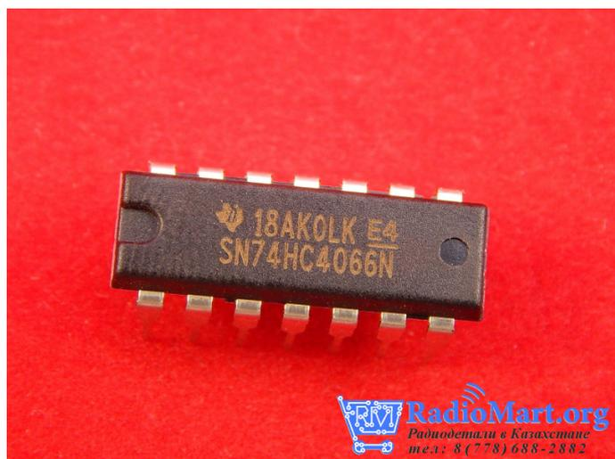
SN74HC4066N, Четыре двунаправленных ключа, DIP-14
