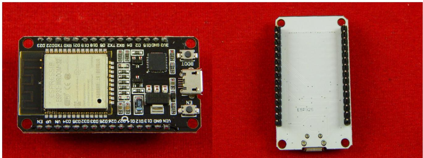
ESP32 — серия недорогих микроконтроллеров с низким энергопотреблением. Представляют собой систему на кристалле с интегрированным Wi-Fi и Bluetooth контроллерами и антеннами. В серии ESP32 используется микроконтроллерное ядро Tensilica Xtensa LX6 в вариантах с двумя и одним ядром.
