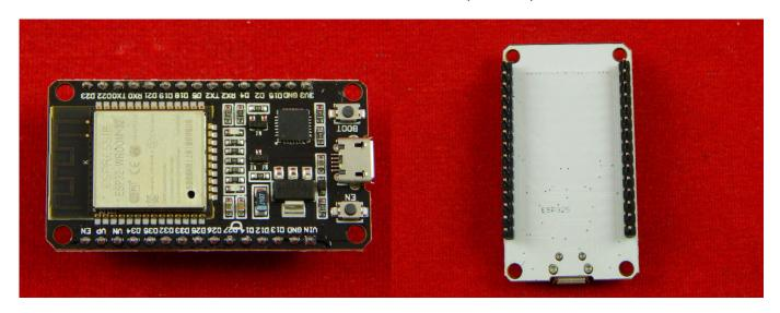
ESP32 — серия недорогих микроконтроллеров с низким энергопотреблением. Представляют собой систему на кристалле с интегрированным Wi-Fi и Bluetooth контроллерами и антеннами. В серии ESP32 используется микроконтроллерное ядро Tensilica Xtensa LX6 в вариантах с двумя и одним ядром.
