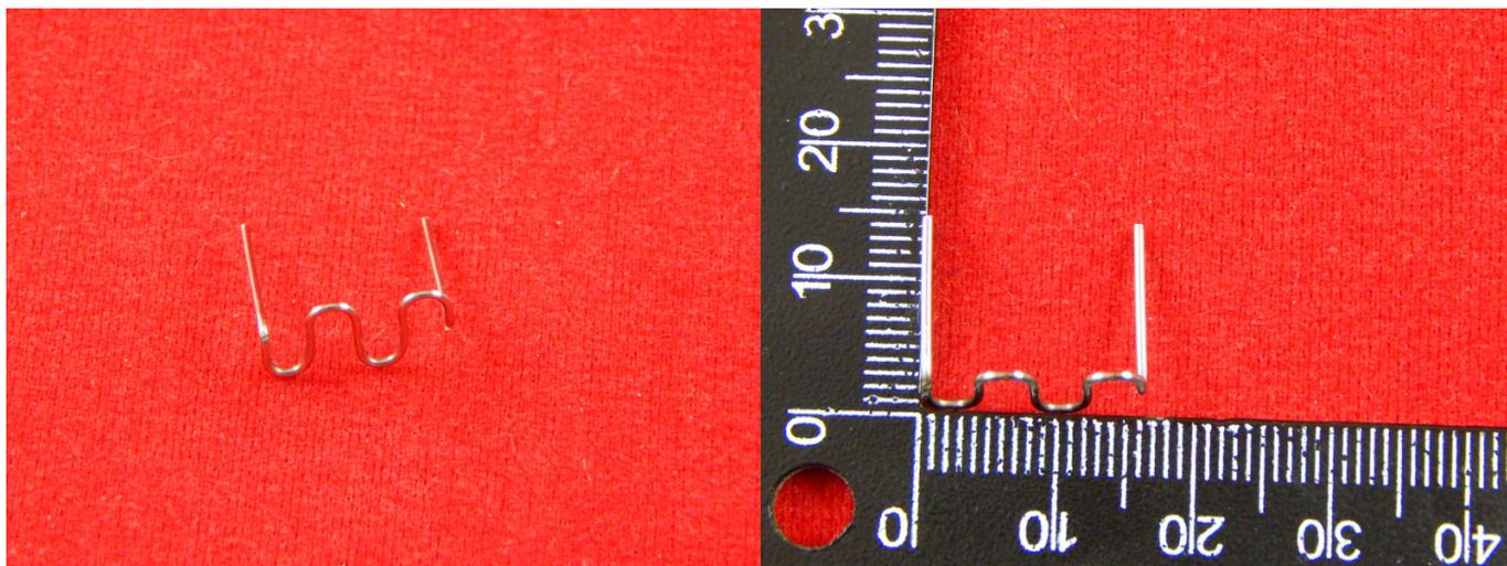
Скобы для паяльника по ремонту пластика, пластмассовых изделий и пайки бампера. Их иногда называют скобы для горячего степлера или скрепка для пайки. Этими скобами можно отремонтировать практически любые изделия из пластмассы. Тип и размер скобы выбирают исходя из толщины и повреждений материала. Обычно скрепки делают из проволоки толщиной 0.6 мм и 0.8 мм.
