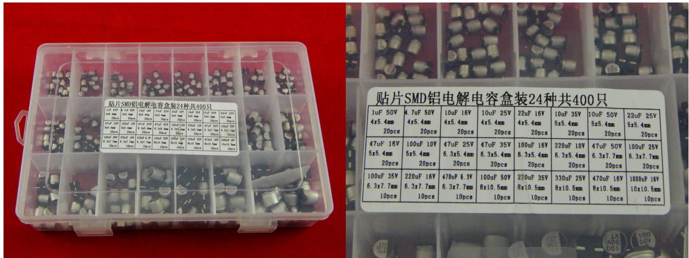
Электролитические SMD конденсаторы – электронные радиокомпоненты, имеющие большую ёмкость и способные накапливать электрический заряд. Такие электролитические конденсаторы предназначены для поверхностного монтажа на печатные платы. Их анод и катод покрывается алюминиевой фольгой, которая разделена технической бумагой, пропитанной жидкими электролитами.
