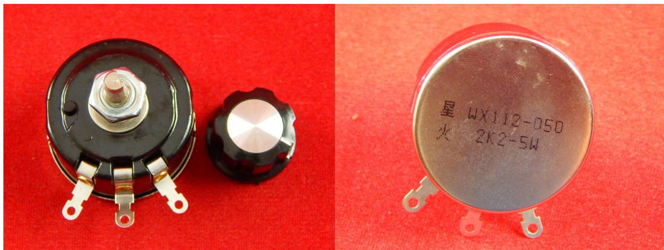
Резистор регулировочный (потенциометр) однооборотный с круговым перемещением подвижной системы - предназначен для работы в электрических цепях постоянного, переменного и импульсного тока.
