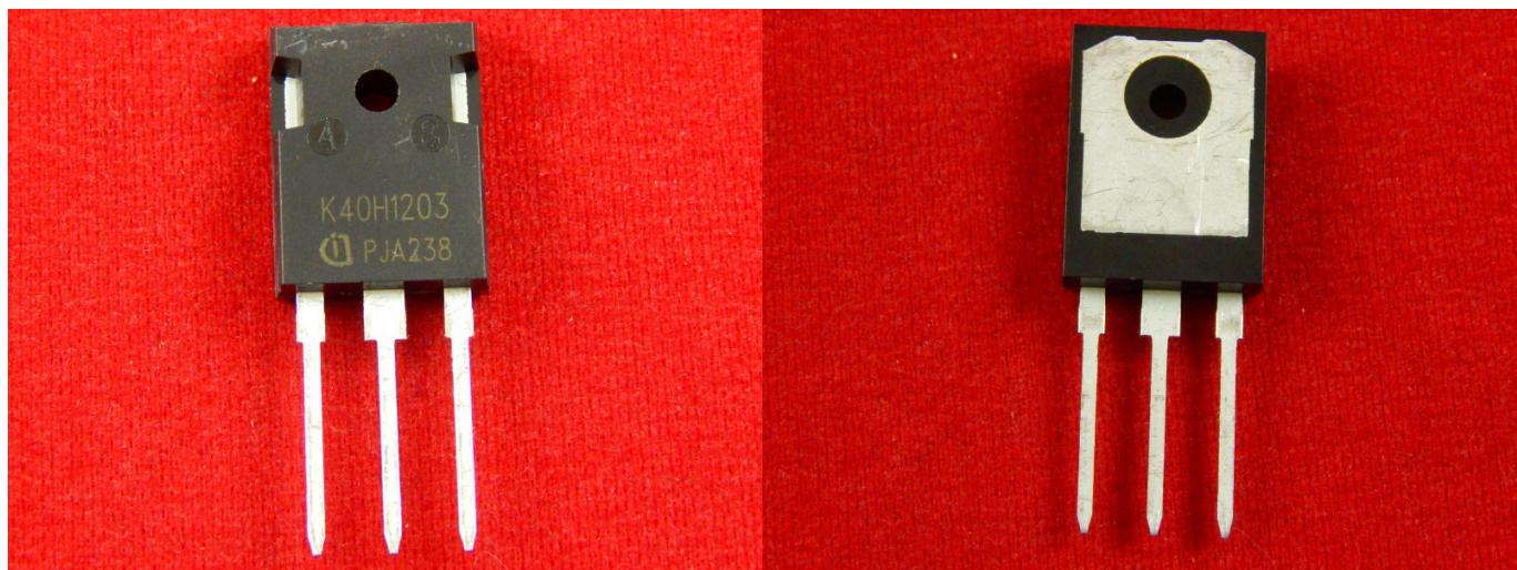
Биполярный транзистор с изолированным затвором - это трёхэлектродный силовой электронный прибор, используемый, в основном, как мощный электронный ключ в импульсных источниках питания, инверторах, в системах управления электрическими приводами.
